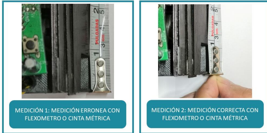
Figura 2: Del lado izquierdo tenemos una medida errónea dado que el flexómetro tiene una variación de movimiento de 1/16 in. Del lado derecho tenemos una medición correcta con el flexómetro dado que el usuario ajusta con sus dedos la variación del instrumento.
