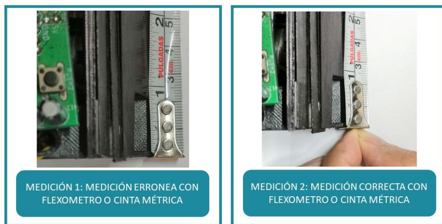
Figura 1: Del lado izquierdo tenemos una medida errónea dado que el flexómetro tiene una variación de movimiento de 1/16 in. Del lado derecho tenemos una medición correcta con el flexómetro dado que el usuario ajusta con sus dedos la variación del instrumento.
